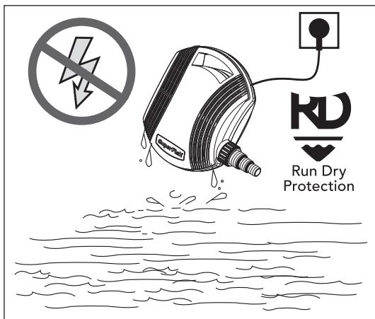
In het geval van oververhitting van de pomp heeft deze een thermische beveiliging tegen overbelasting. In het geval van oververhitting van de motor, schakelt het apparaat automatisch de pomp uit. De afkoeltijd bedraagt ongeveer 15 tot 20 minuten, dan wordt de pomp automatisch weer ingeschakeld. Als de motorbeveiliging is geactiveerd, is het essentieel te onderzoeken wat de oorzaak is van de oververhitting en deze op te lossen.
